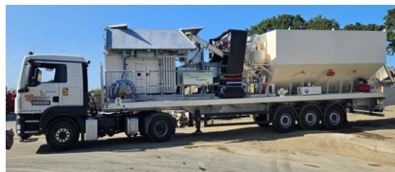
Ce procédé a pour objectif de traiter les matériaux destinés aux couches de formes des **zones inaccessibles avec les engins utilisés pour le procédé de traitement classique**, évoqué précédemment. Ces matériaux extraits et traités pourront ensuite être remis en place et nivelés à la pelleuse mécanique dans les espaces concernés.
